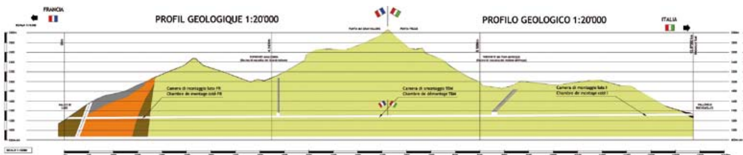
Profilo geologico della nuova galleria con in evidenza le centrali di ventilazioni sotterranee esistenti e i punti di montaggio e smontaggio delle Tbm
