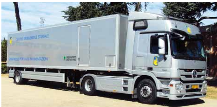
L'autoarticolato su cui è montato il sistema Tsd
