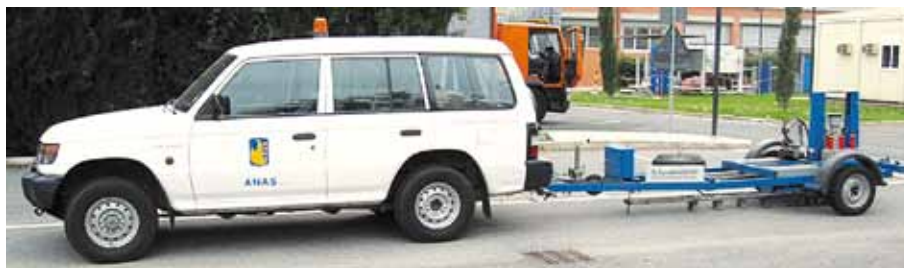
Veicolo e schema di funzionamento del sistema di rilevamento Falling weight deflectometer (Fwd)
