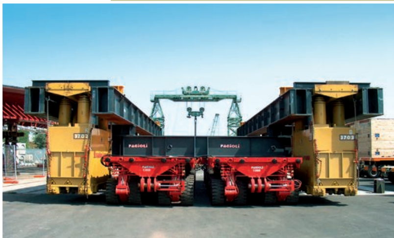
Vista del sistema di appoggio e rotazione ideato per il trasporto e la messa in opera del concio centrale
