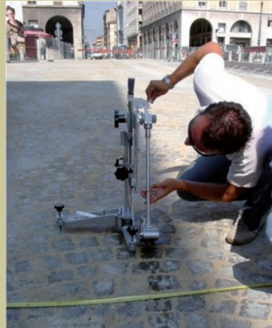
Misure di aderenza (Skid tester)
