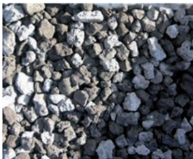
Particolari di provini per lo studio di possibilità di impiego nella sovrastruttura stradale di scorie di lavorazione degli acciai, degli sterili di cava, di aggregati riciclati
