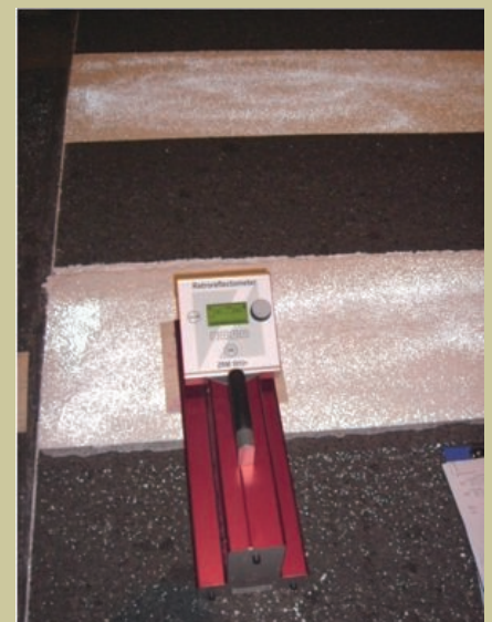
Misure di prestazioni di segnaletica orizzontale (Retroriflettometro)
