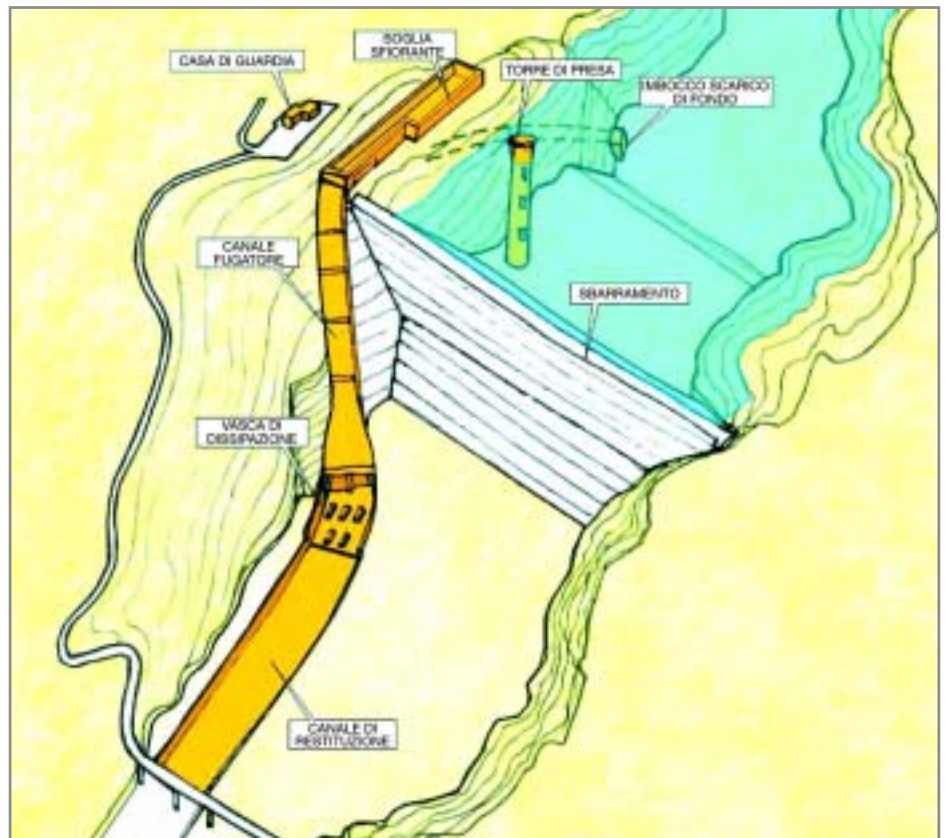
Vista assometrica e planimetria generale dell'area di intervento della Diga di Bluffi
