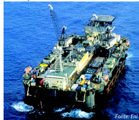
La nave Castoro sei di Snamprogetti, utilizzata per la posa del gasdotto sottomarino fra la Libia e la Sicilia
