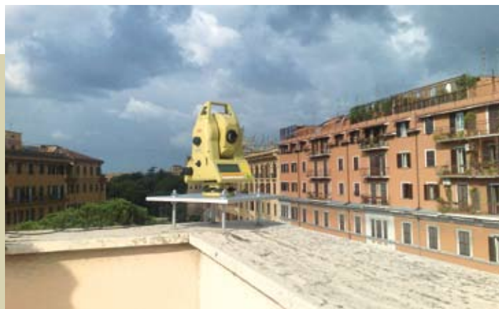
Stazione Robotizzata Leica TCA2003 in Postazione Fissa di Monitoraggio Automatico di Superficie
